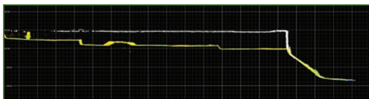
Рис. 14 Поперечный разрез совмещенных цифровых моделей Балки за 2017 г. (белая линия) и 2018 г. (желтая линия)
