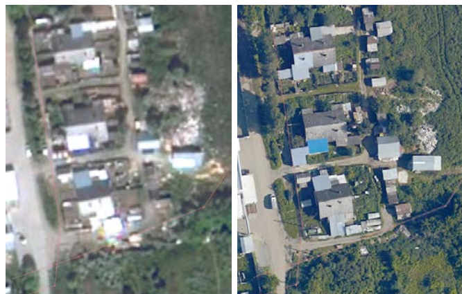
Рисунок 1 - Сравнение разрешения космических (слева) и аэрофотоснимков (справа).
