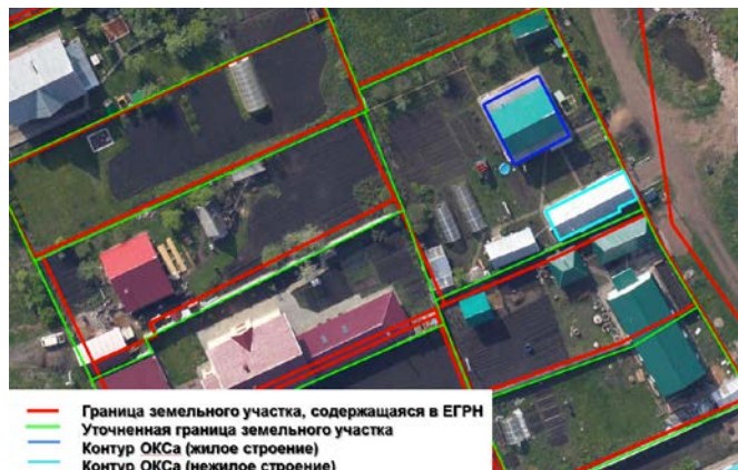
Рисунок 2 – Стереофотограмметрическое определение местоположения объектов недвижимости для карт-планов.
