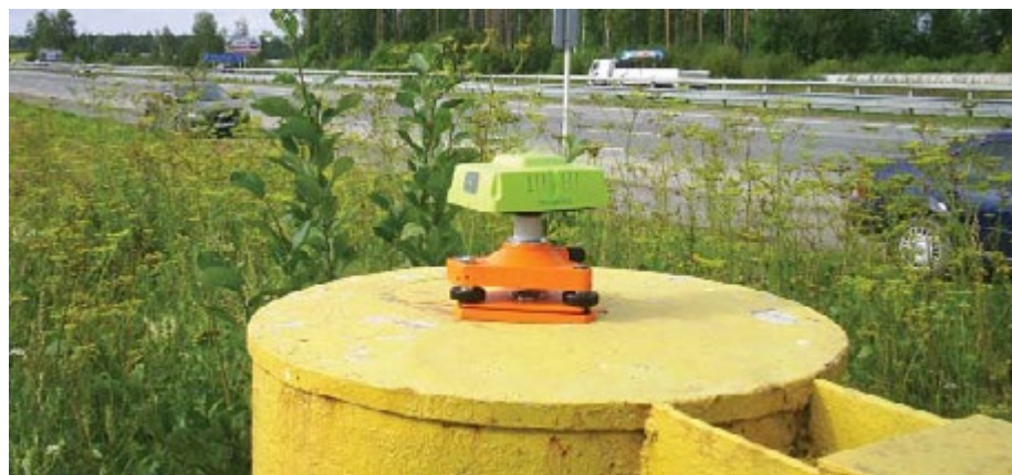
Рис. 2 Приёмник «Triumph-2» установлен на пилоне № 0
