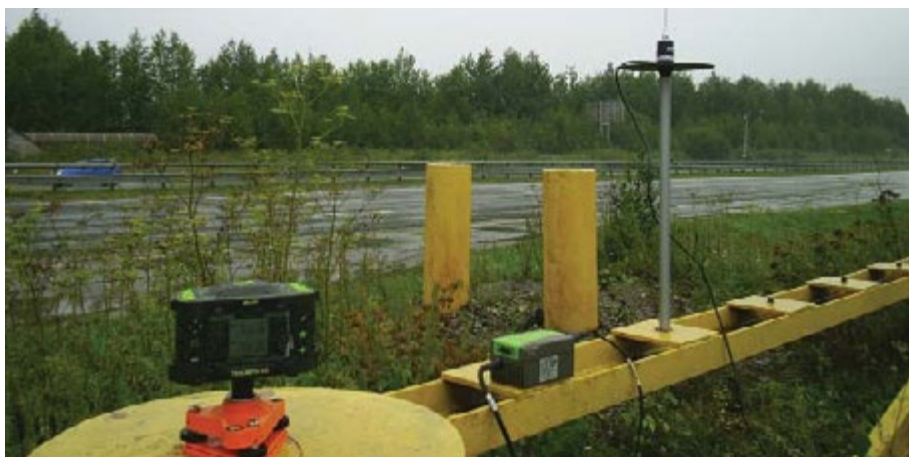
Рис. 5. Базовая станция с передающей аппаратурой для кинематики в реальном времени
