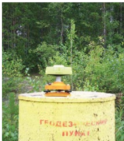
Рис. 3. Приёмник «Triumph-2» установлен на пилоне № 11
