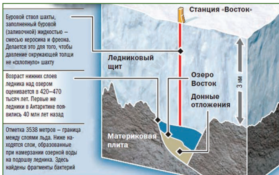
Рис. 4 Схема размещения ствола скважины, пробуренной в районе станции «Восток» в 2012 г.
