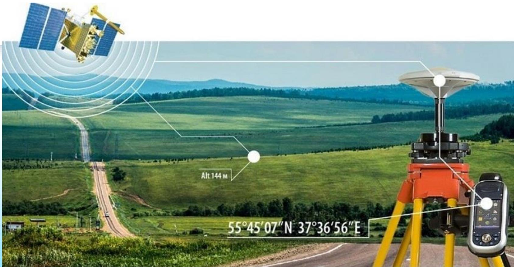
Сегодня для определения границ земельных участков применяются высокоточные геодезические приборы, в том числе спутниковые приемники.
